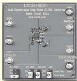
Рисунок 1 Два DC/DC регулятора на основе LTC3548 занимают на плате площадь <math>< 1.3 \text{ см}^2</math>
