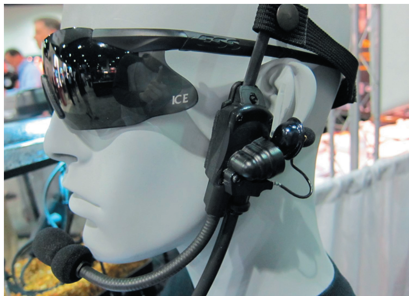
Рис. 2. Пример реализации водонепроницаемой тактической гарнитуры с передачей голосовых сигналов костной проводимостью
