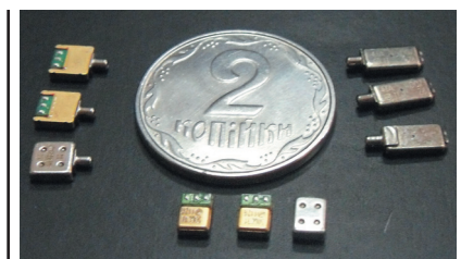
Рис. 1. Внешний вид микрофонов и телефонов компании Sonion (звукоизлучатели серии 4100, микрофоны серий 5000 и 6500T)
